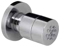
BELA - Wall mounted body jet rain Minimum flow rate required: 4 l/min. at 3 bar BELA - Buse latérale RAIN. Requier un débit minimum à 3 bars de 2 l/min.
